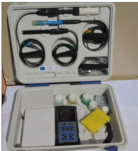
Obr. 28: Prenosný multimeter na terénne meranie hodnôt pH, Eh, teploty, obsahu rozpusteného kyslíka a mernej elektrickej vodivosti
