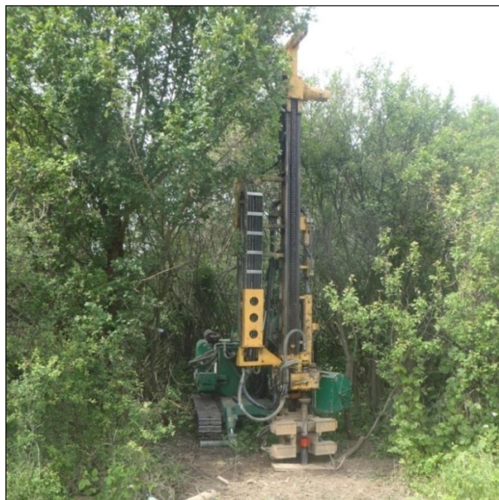
Obr. 62: Vrtná súprava Fraste MITO-40 na vrte ZP-6 (foto: J. Schwarz, 2014)
