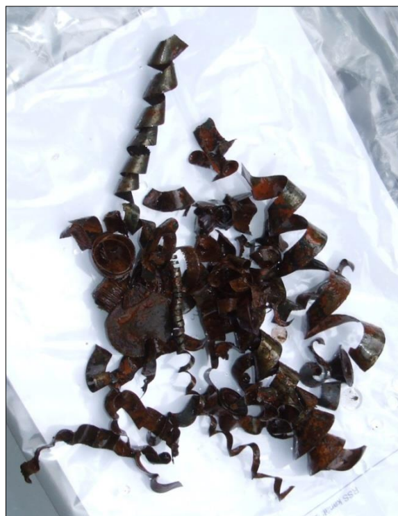
Obr. 39: Náplň reakčnej bariéry – odpadové Fe špony – po 4 mesiacoch fungovania pasívneho čistiaceho systému
