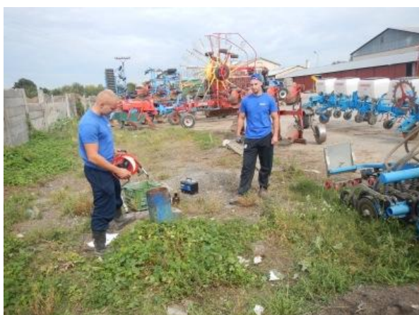
Obr. č. 6 a 7 Odber vzoriek podzemných vôd počas etapy sanácie environmentálnej záťaže
