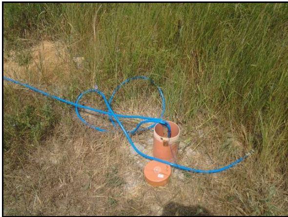
Obr. č. 17 a 18 Oxidácia plynným O 2 v lokalitách Pekáreň a Sklady
