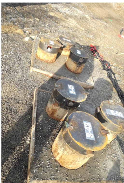
Obr. č. 23 a 24 Zabudované reakčné brány a osádzanie reakčných košov
