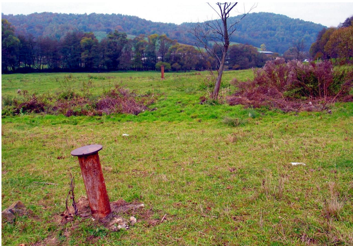
Obr. č. 3 Monitorovacie vrty pod štátnou cestou, stav pred sanáciou (zdroj: ISEZ)
