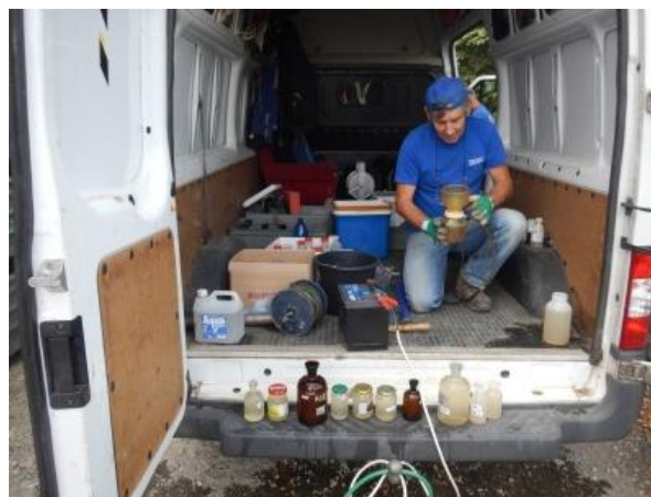
Obr. č. 6 a 7 Odber vzoriek podzemných vôd počas etapy sanácie environmentálnej záťaže
