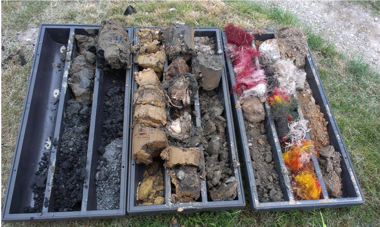
Obr. č. 4 a, b, c Odber vzoriek zemín v ochrannom obleku (a), odber ihneď po odvrtaní (b), profil vrtného jadra s výrazným znečistením (c).
