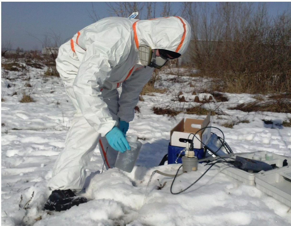
Obr. č. 4 a, b, c Odber vzoriek zemín v ochrannom obleku (a), odber ihneď po odvrtaní (b), profil vrtného jadra s výrazným znečistením (c).
