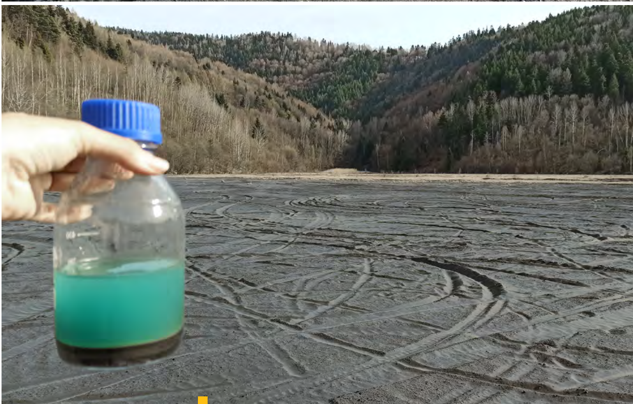
14 Z ťažobného odpadu s vysokým obsahom medi sa realizovali testy lúhovania s rôznymi médiami. Na obrázkoch hore je precipitačný proces s vápnom v 50 l výluhoch. Na obrázkoch v strede a dole vizuálny efekt extrakcie kovov vo fľašiach.
