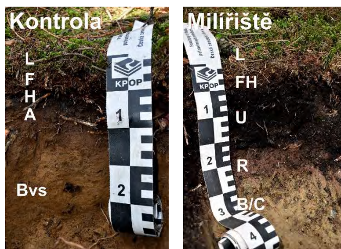
Obr. 1 Půdní profil v prostoru milířiště (vpravo) a cca 25 m vzdálená kontrola (vlevo) bez vlivu pálení uhlí z lokality Český les. L – horizont opadanky, FH – horizonty drti a měli, U – vrstva uhlí z pálení milíře, R – teplem z pálení milíře ovlivněná vrstva (U a R nejsou označení horizontů ve smyslu klasifikace půd ČR), A – organominerální horizont, Bvs – horizont spodický rezivý, B/C – přechod minerálního horizontu a půdotvorného substrátu.
