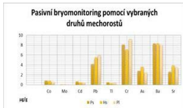
Obr. 6: Srovnání pasivního biomonitingu pomocí mechorostů Pleurozium schreberi (Ps), Hylocomium splendens (Hs) a Paraleucobryum longifolium (Pl).
