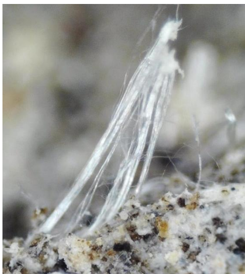
Obr. 3: Eternit, azbest pod monokulárom (30x).
