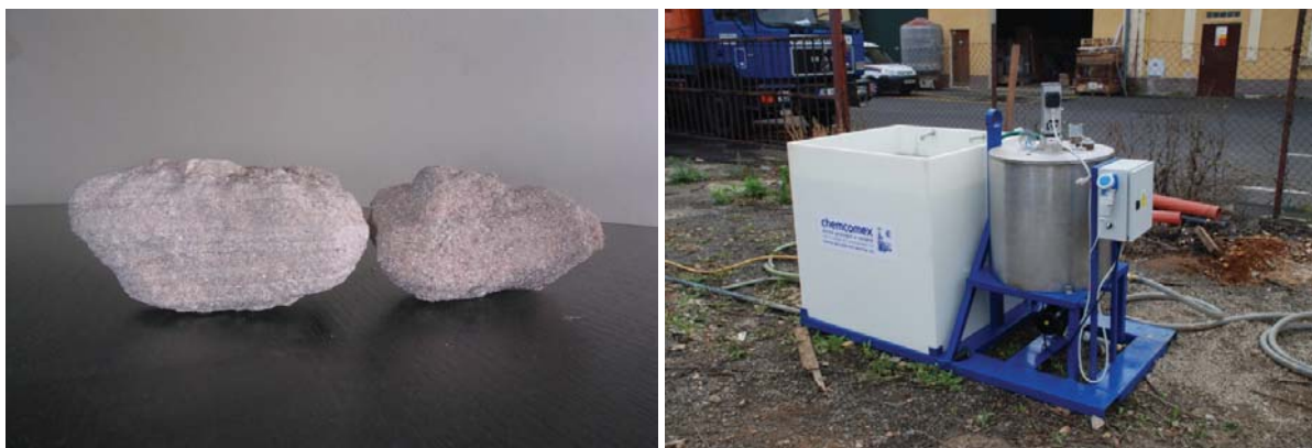
Obr.1 Kvartérní písek stmelný do antropogenního pískovce (vlevo)
